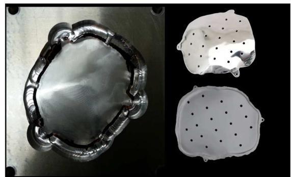
Figura 3: Se transforman el formato DICOM a STL, posteriormente se realiza el diseño de la prótesis en espejo a lado contralateral y finalmente se realiza el acoplamiento de la prótesis y el cráneo.
